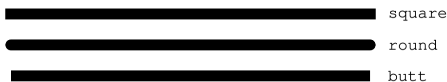
图 4: PS_LINE_CAP 控制线段端点绘图效果
